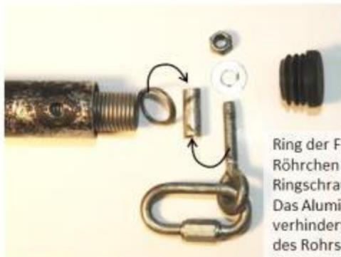
Ring der Feder über Aluminium-Röhrchen stülpen und im Rohr Ringschraube durchschieben. Das Aluminium-Röhrchen verhindert das Zerquetschen des Rohrs!
