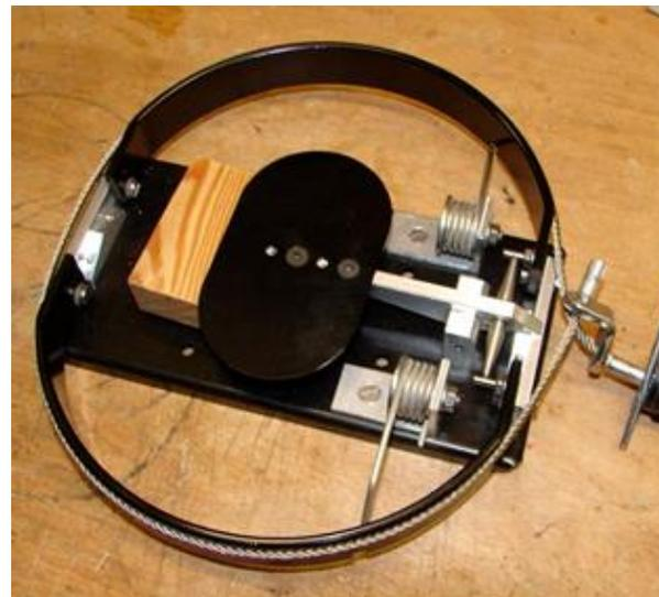
Abb. 7. Fuss-Schlingefalle Type „KORA 08“ mit ausgezogenem Kabel um die Wurfbügel.
