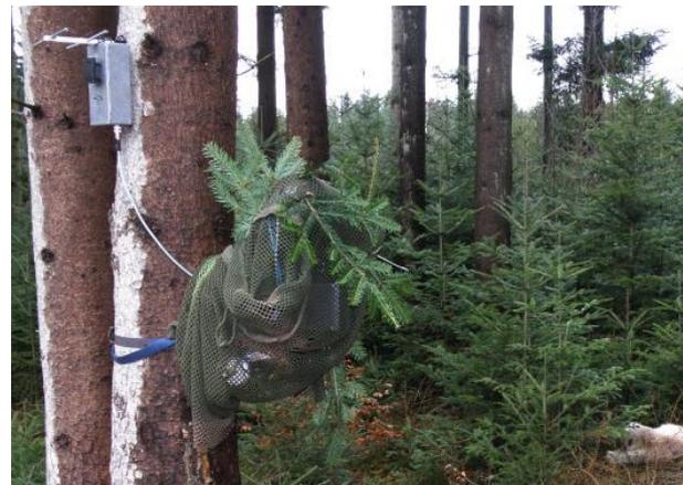
Abb. 14. Der MICS getarnt mit Richtantenne zur Kommunikation mit der Steuereinheit. Im Hintergrund das Beutetier des Luchses.
