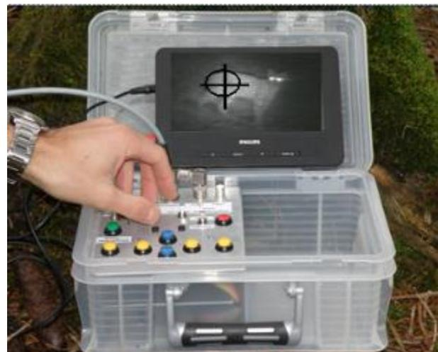
Abb. 16. Die Steuereinheit des MICS mit dem Bildschirm mit aufgeklebtem Fadenkreuz, das nach dem Justieren den Auftreffpunkt des Blasrohrpfeils markiert.
