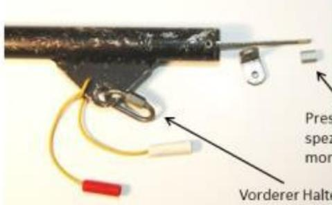
Presshülse mit spezieller Zange montieren!
