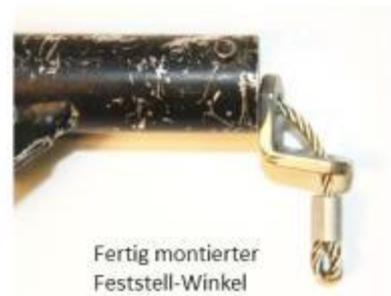
Fertig montierter Feststell-Winkel
