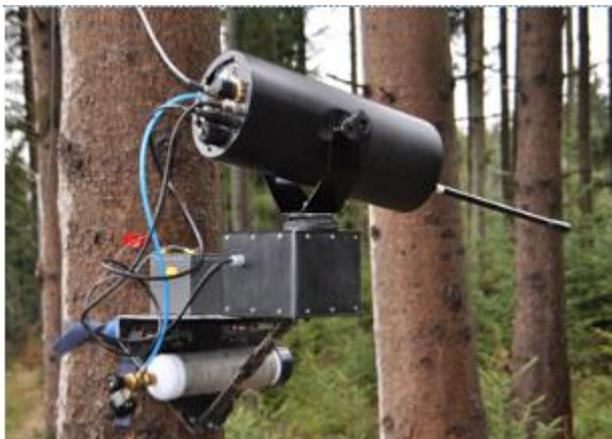
Abb. 13. Die neueste (dritte) Generation des MICS (Minimally Invasive Capture System) noch ungetarnt an einem Baum in ca. 10 Meter Entfernung vom Beutetier montiert.
